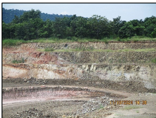
ภาพที่ 2.11 การทำเหมืองแบบขั้นบันได
